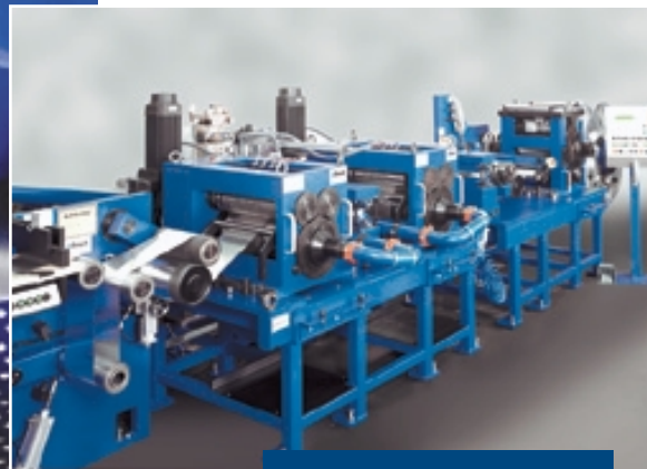
Baust Rotationsprozessor mit Stanz- und Prägevorrichtung
